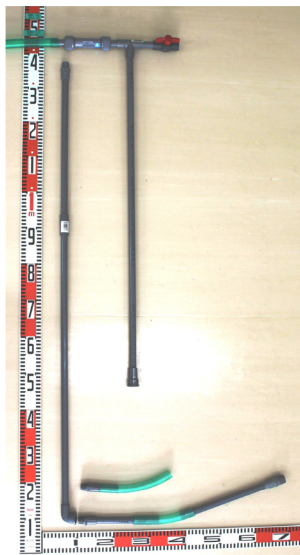
【写真－5】散気攪拌装置
