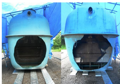
写真-1 構造例示型の破損例
