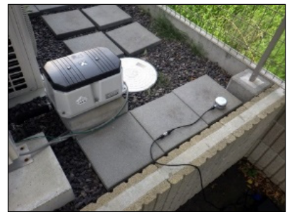
写真-5 振動測定の状態
